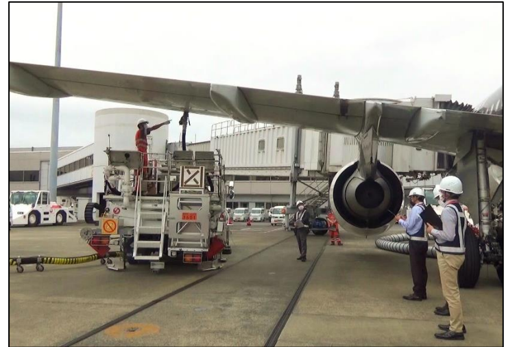
ノズルユニットの接続状態を確認
